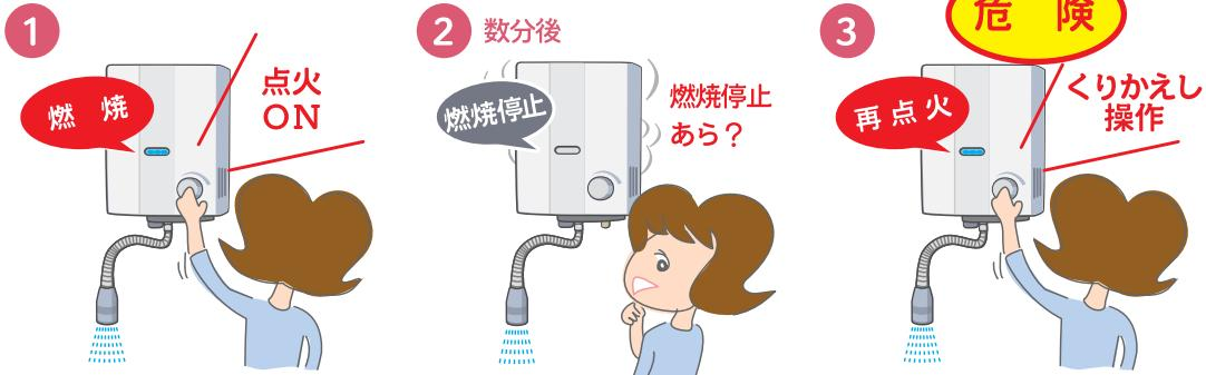
使用中、燃焼停止した時は、一酸化炭素が発生しています。再点火して繰り返し使用すると、一酸化炭素中毒(CO中毒)になる恐れがあります。
