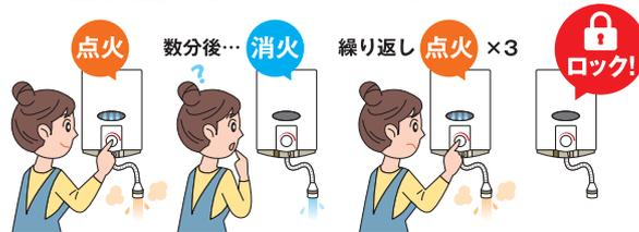
最新の小型湯沸器には、立消え安全装置、過熱防止装置、消し忘れ防止装置が標準装備されています。また、安全装置が作動するとランプの点滅や点灯の他、音声で知らせてくれる機種もあります。
