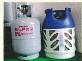
液化石油ガス用容器の外観の比較 左: 鋼製の溶接容器(8kg型容器、容器だけの質量は9.6kg) 右: 一般複合容器(7.5kg型容器、容器だけの質量は4.4kg) (写真提供: 中興工業株式会社)
